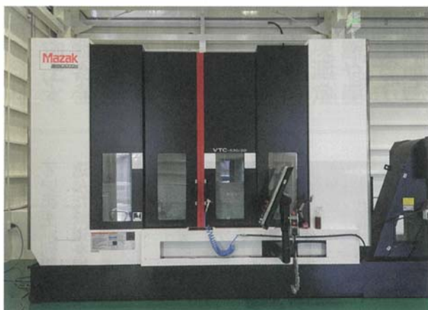
マシンニング ヤマザキマサック VTC-530/20 加工範囲：φ50×530×510
